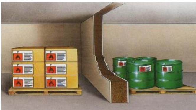
Figura 15. Almacenamiento separado de productos incompatibles
