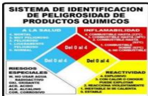
Figura 21. Sistema de identificación de peligrosidad.
