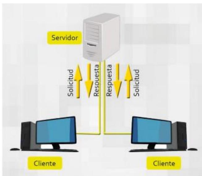
*Nota:* Se explica el funcionamiento de la arquitectura cliente / servidor empleada por los servidores web, fuente y elaborado por Gutiérrez (2018)
