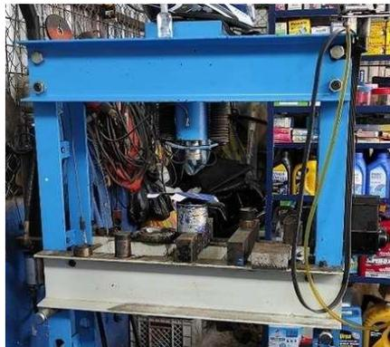
**Figura 63. Prensadora hidráulica de rodamientos**
