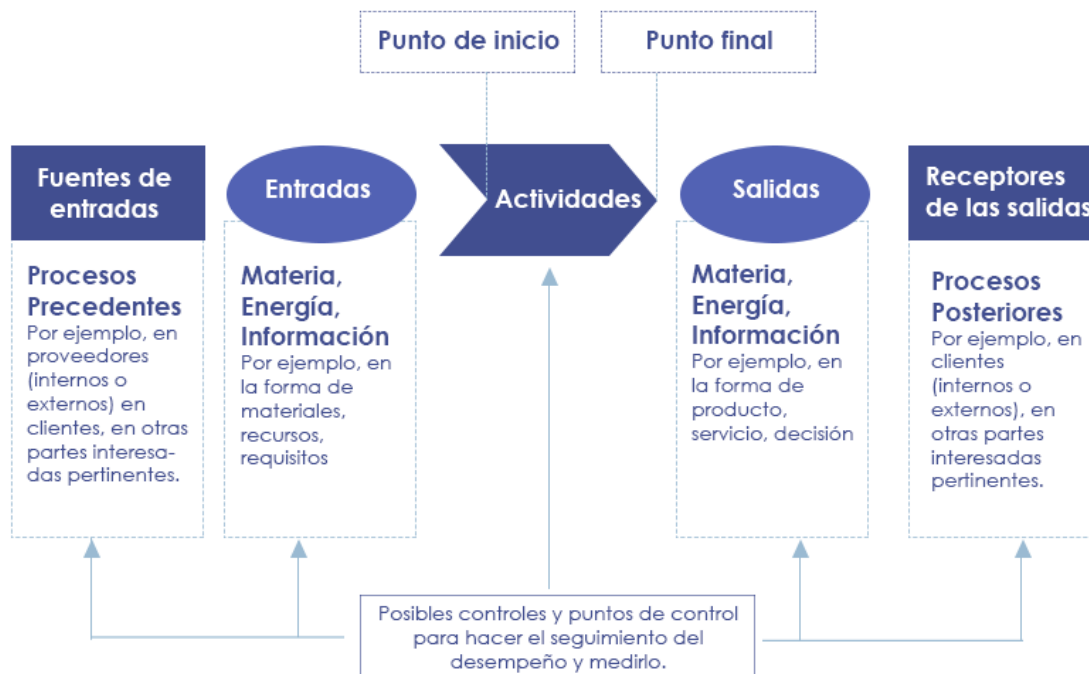
FIGURA 9 REPRESENTACIÓN ESQUEMÁTICA DE LOS ELEMENTOS DE UN PROCESO Fuente: ISO 9001-20015 (ISO 9001, 2015)
