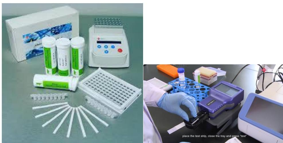
**Figura 3.** Componentes del Kit rápido para Aflatoxina M1
