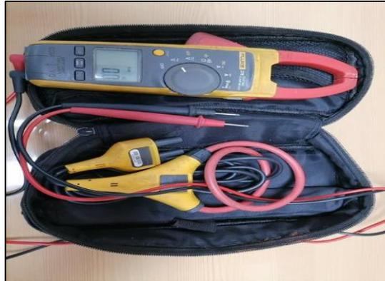
*Figura 9.* Pinza voltiamperimetrica digital FLUKE 376.
