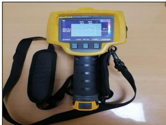
*Figura 8.* Cámara Termográfica FLUKE Ti32. Fuente: Elaboración propia.
