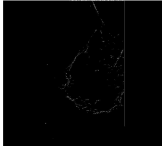
Ilustración 11: binarización mediante el operador de Sobel de MDB001
