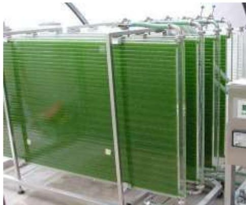
**Figura 6.** Fotobiorreactor de panel plano
