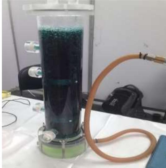
**Figura 7.** Fotobiorreactor de columna de burbujeo
