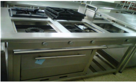
Figura N° 15: Cocina Industrial con Horno
