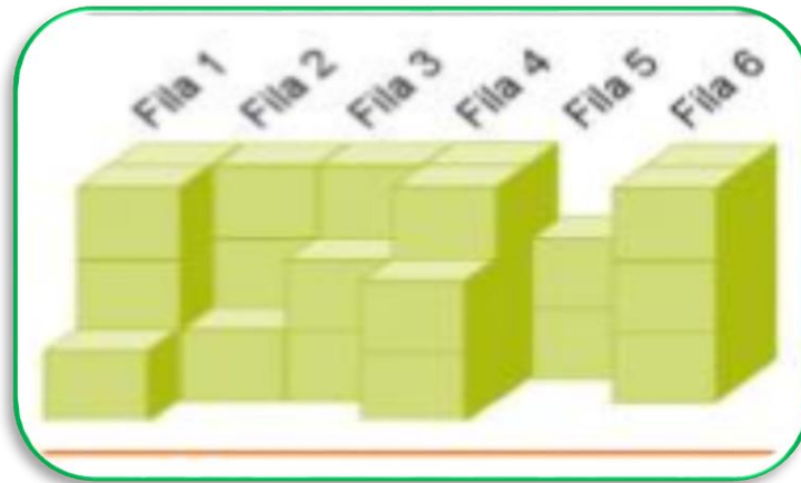
Figura 9. Almacenaje en bloque.
