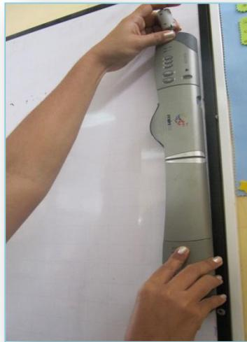
2. Empezamos a colocar el cable USB en nuestra PC o portátil, y luego en la parte inferior del dispositivo Mimio.
