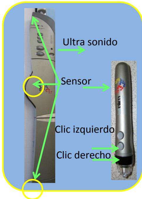
Es un dispositivo portátil, se lo utiliza con un sistema electrónico avanzado, es fácil de manipularlo, se lo puede acoplar en la pizarra de fibra o normal que utilizamos en la sala de clase e incluso en la pared.
