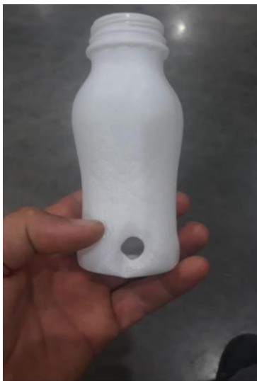
Imagen 1: Producto defectuoso por causa de la materia prima
