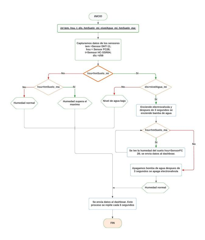
Diagrama 3 funcionamiento y proceso del diagrama de flujo del sistema
