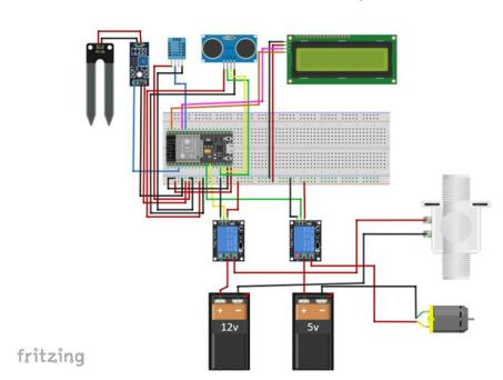
Diseño del circuito del sistema de riego automatizado
