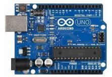
Ilustración 14 Placa arduino uno
