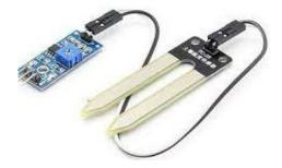
Ilustración 8 Sensor de humedad del suelo
