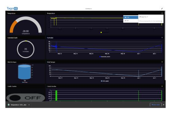
Ilustración 27 Validación del nivel de agua, humedad del suelo y por sentaje de humedad del suelo
