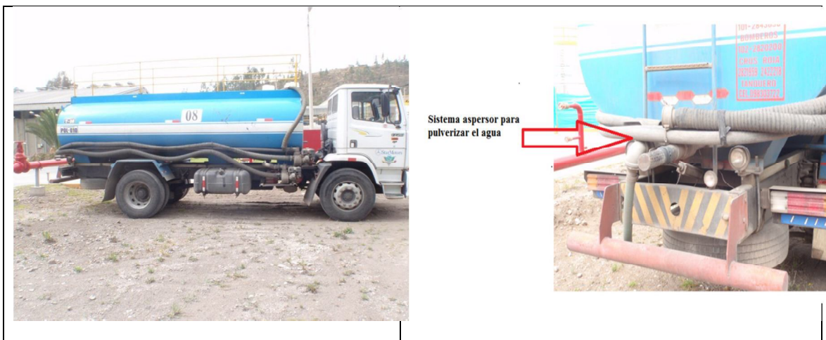
Figura 10. Tanquero para humectación de vías de cantera. Cap. 3000 galones
