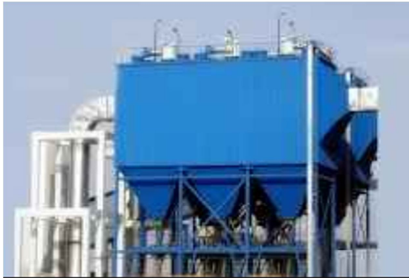
Figura 12. Precipitador electrostático en una industria
