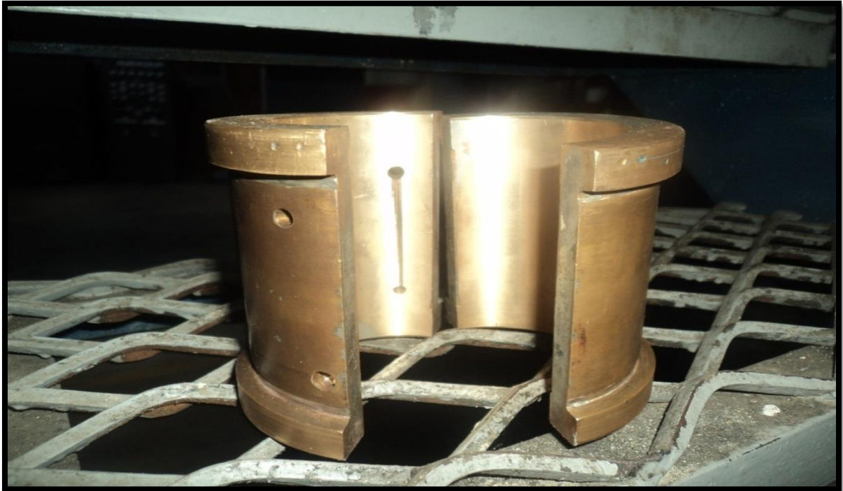
Figura 39. Cojinete sometido a limpieza superficial.
