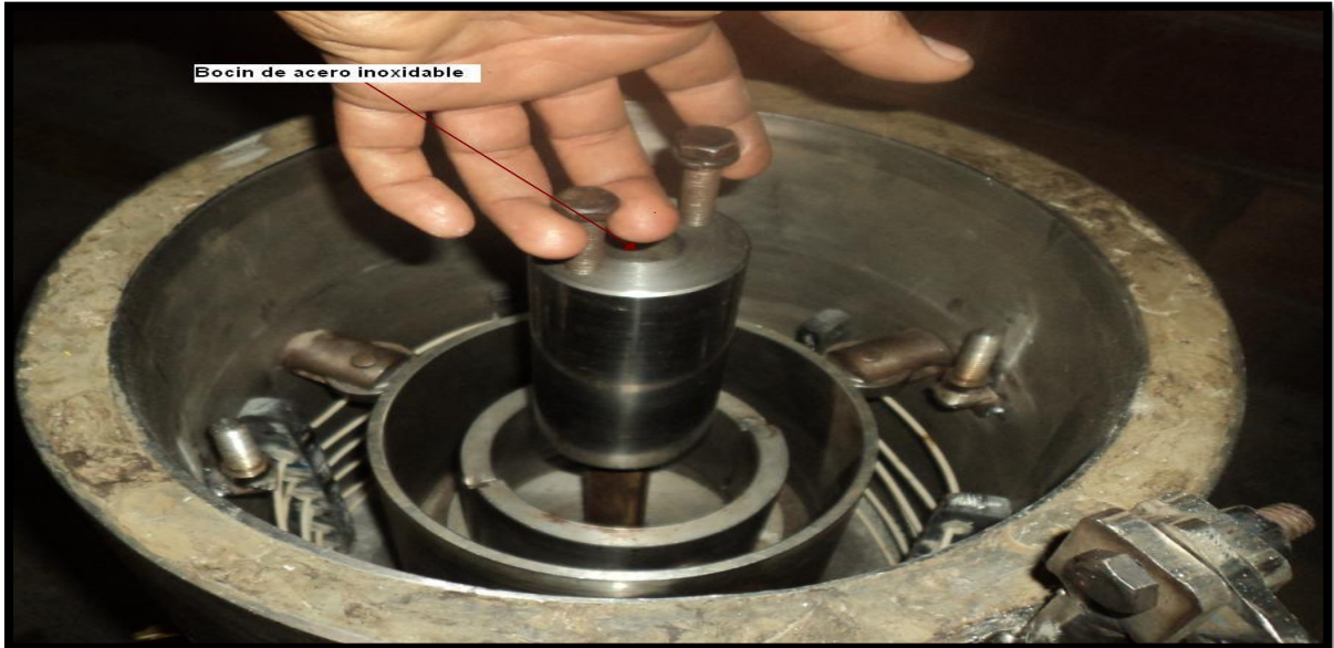
Figura 33. Bocín de acero inoxidable empleado para conseguir espesor del recubrimiento.
