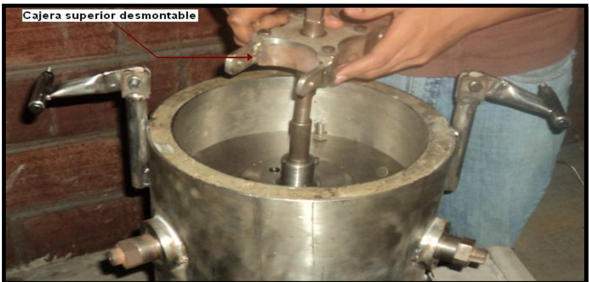
Figura 36. Cajera superior diseñada para facilitar la entrada y salida del cojinete reconstruido.
