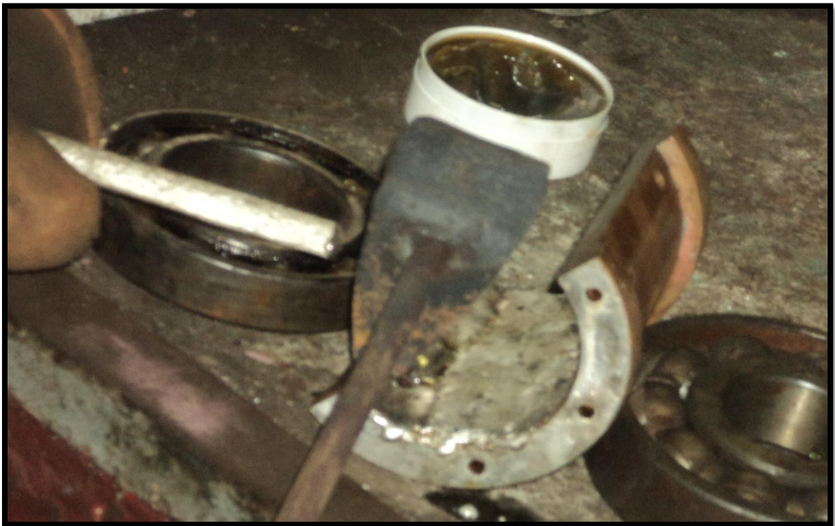
Figura 14. Método de aplicación manual de magnolia fundida por caudín.
