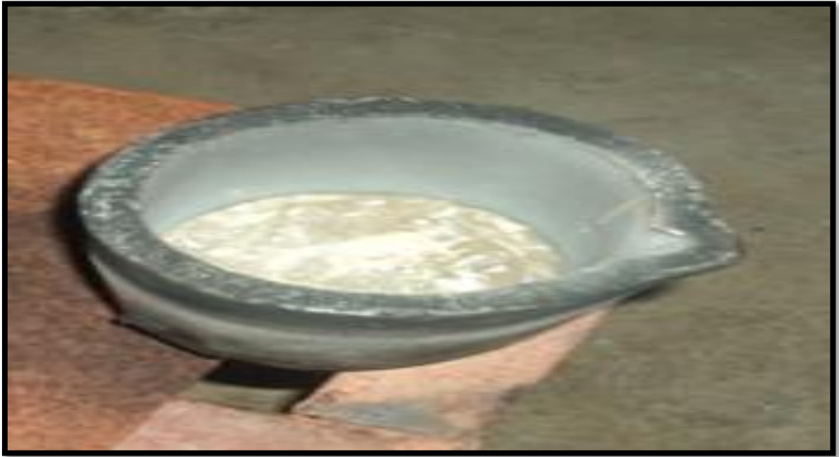
Figura 41. Babbitt en estado líquido dentro del crisol.
