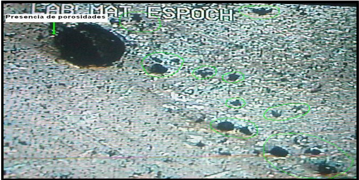
Figura 15. Análisis macro de un cojinete reconstruido con caudín
