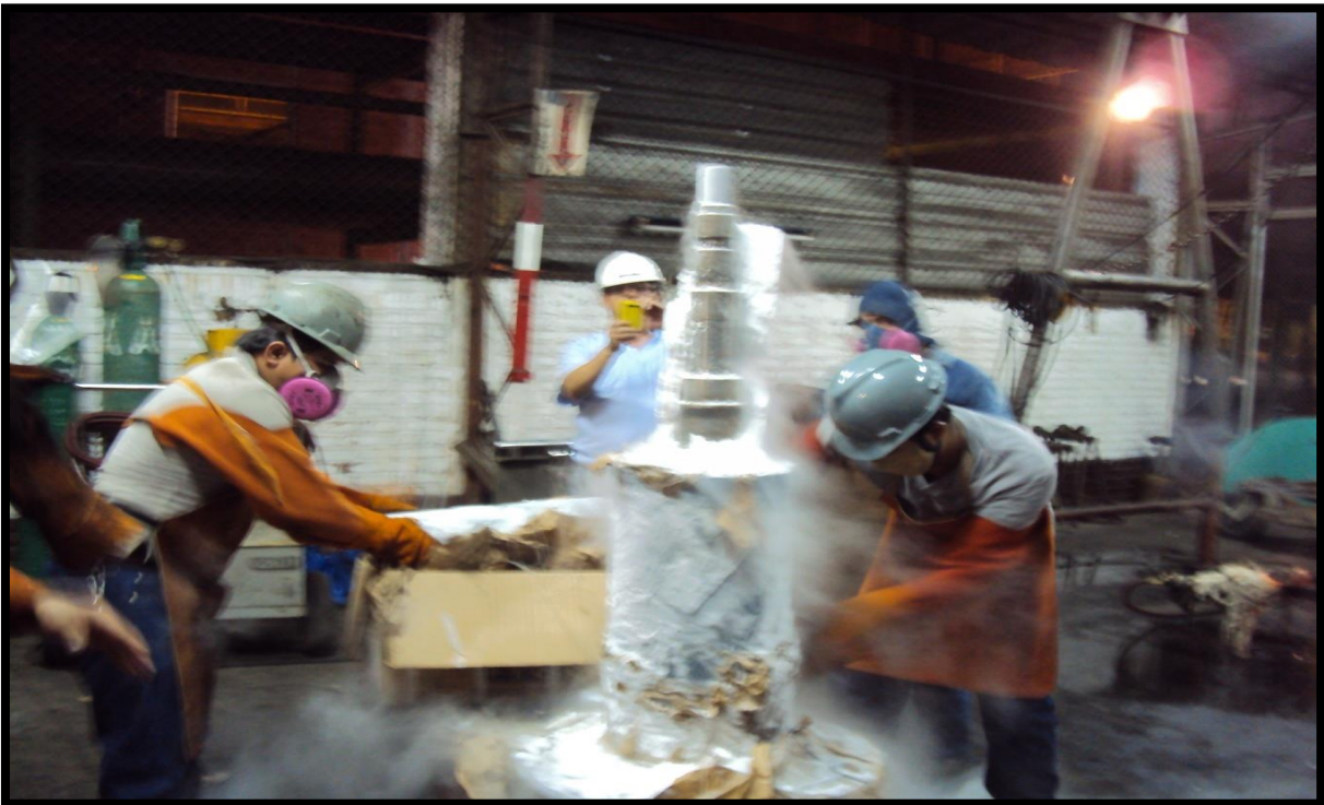
Eje de turbina contraído con la aplicación hielo seco.
