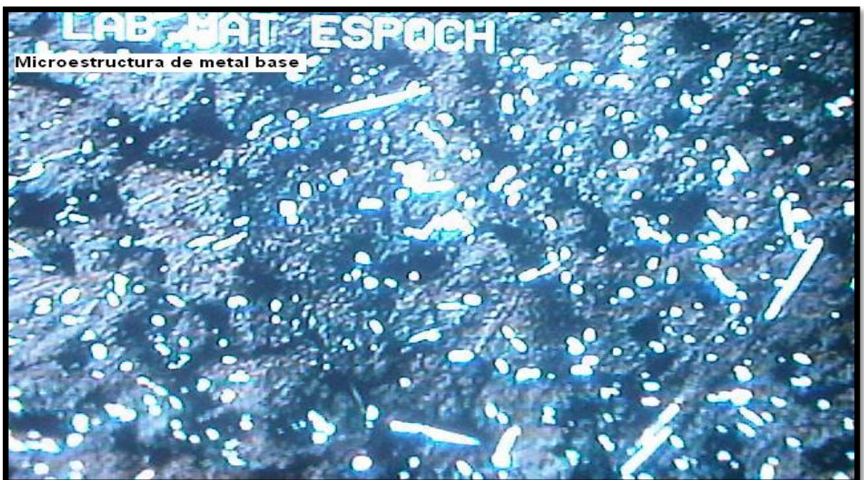
Figura 19.: Bronce fosfórico expuesto a tres minutos de ataque con nital 2
