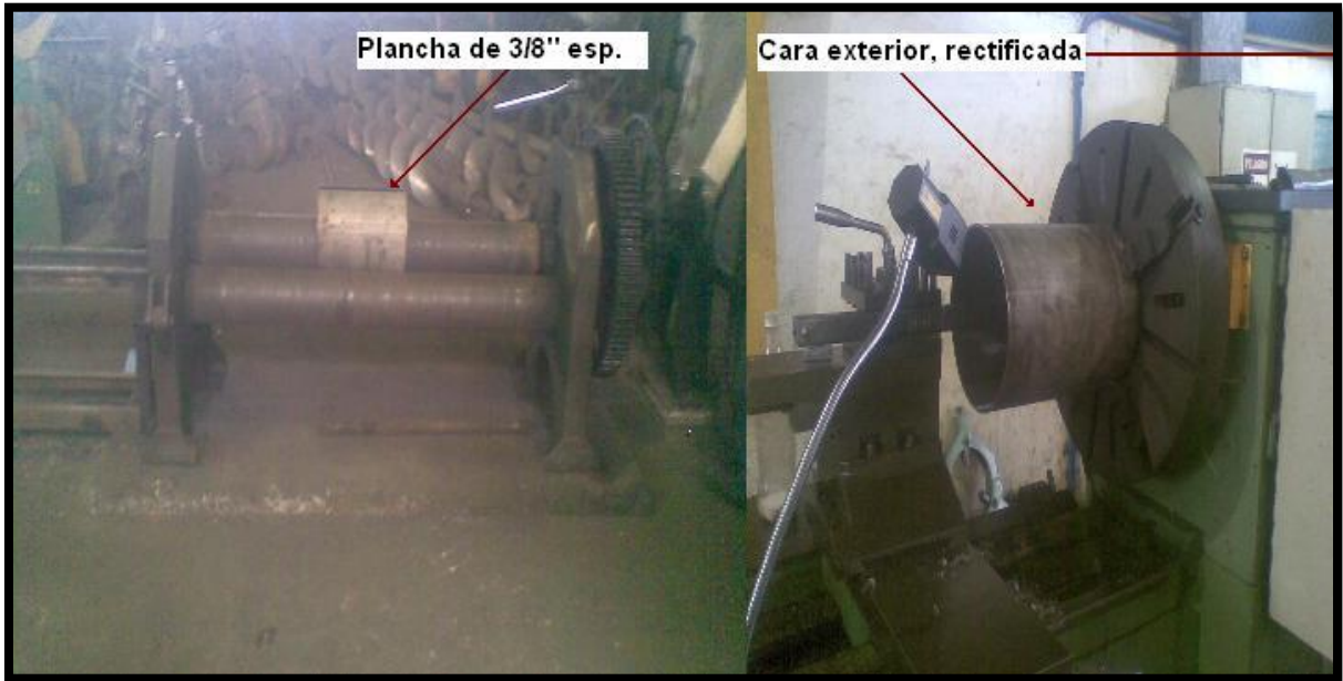
Figura 23. Proceso de rolado y rectificado de cara externa de dispositivo.
