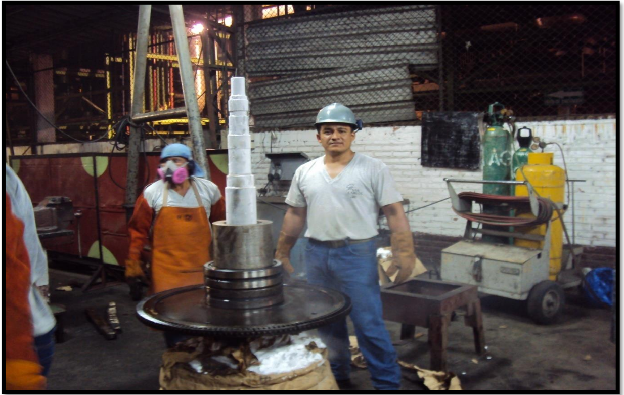
Finalización del trabajo de montaje del disco de turbina.
