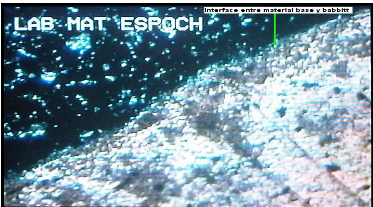
Figura 17: Cojinete de fricción cubierto con Babbitt y sin rectificar expuesta 10 segundos al ataque químico, con 10\times=375\mu\text{m} de aumento. Lado. Der. Interface entre el recubrimiento y el metal base.
