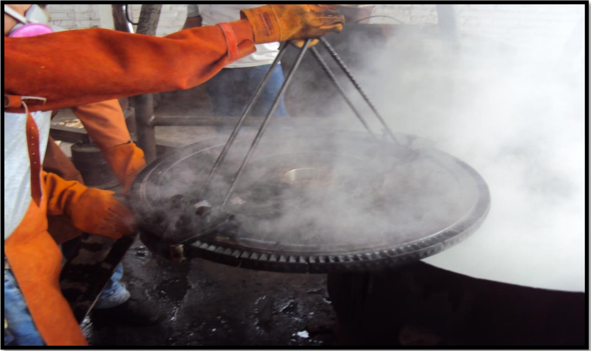
Disco de turbina dilatado por el calor.
