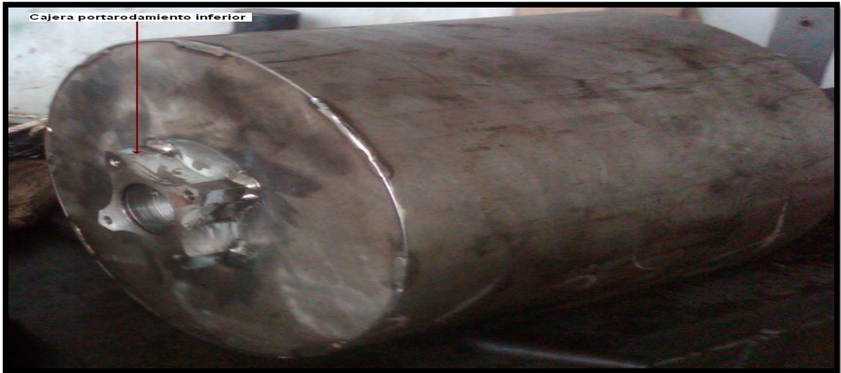
Figura 35. Vista inferior del dispositivo durante su construcción.
