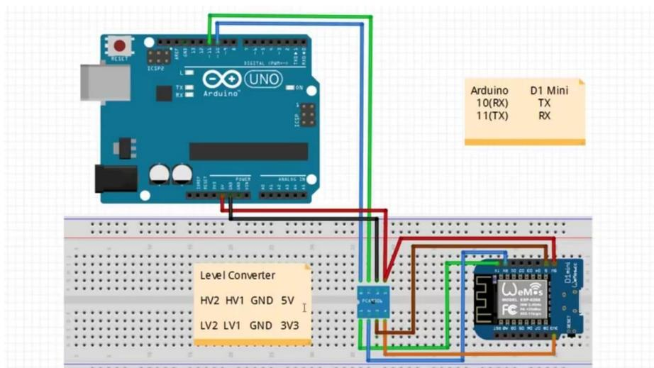
Ilustración 20: Conexiones de Arduino en Protoboard
