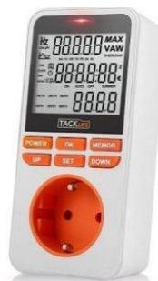
Ilustración 5: Medidor de Consumo Eléctrico TACKLIFE
