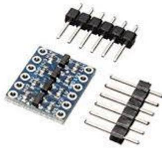
Ilustración 16: CONVERTOR DE NIVEL LOGICO 3.3/5V
