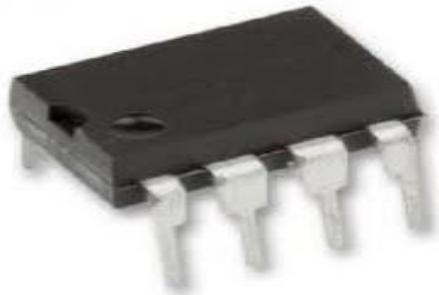
Ilustración 11: CIRCUITO INTEGRADO LM358
