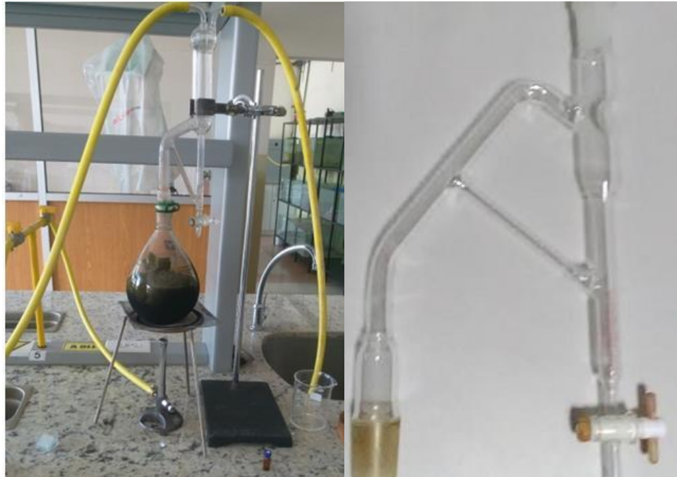
Figura 15. Hidrodestilación adaptado a Clevenger con mechero de bunsen, para obtener el aceite esencial de la Chuquiraga jussieui
