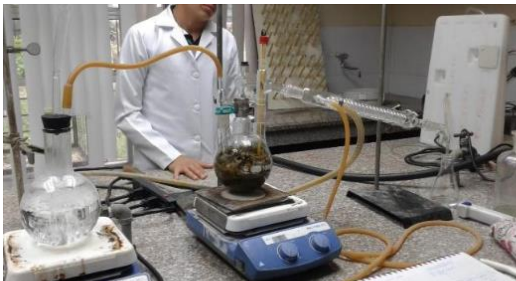
Figura 16 Proceso de hidrotésilación destilación por arrastre de vapor de aceite esencial de la Chuquiraga jussieui .
