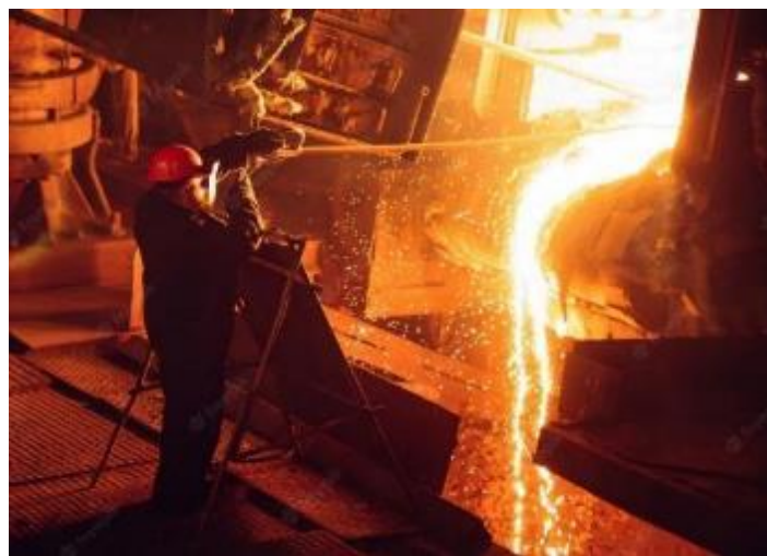
Figura 14. Medición de temperatura de acero líquido en horno de arco eléctrico.
