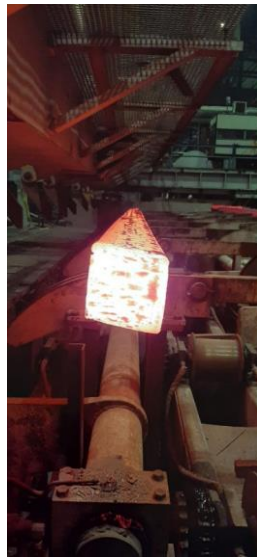
Figura 40. Palanquilla con romboides alta por temperatura inadecuada
