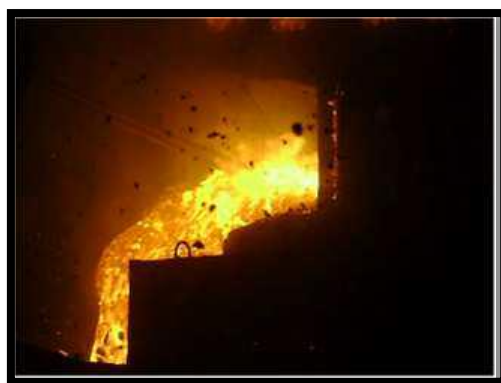
Figura 12. Escoria Espumosa en la etapa de afino del EAF
