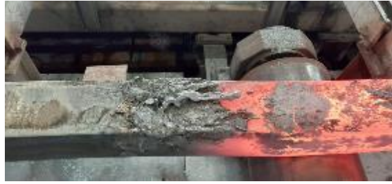
Figura 39. Palanquilla con perforación por temperatura inadecuada
