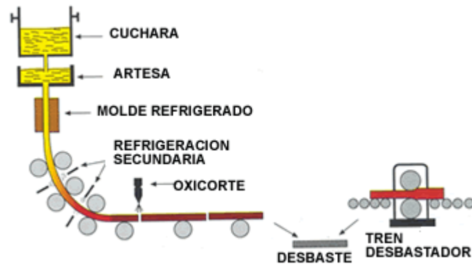
Figura 6. Área de colada continua, parte inferior
