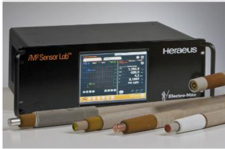
Figura 15. Maquina Heraus receptora de señal de medición de temperatura y nivel de oxidación del acero líquido en la etapa de afino
