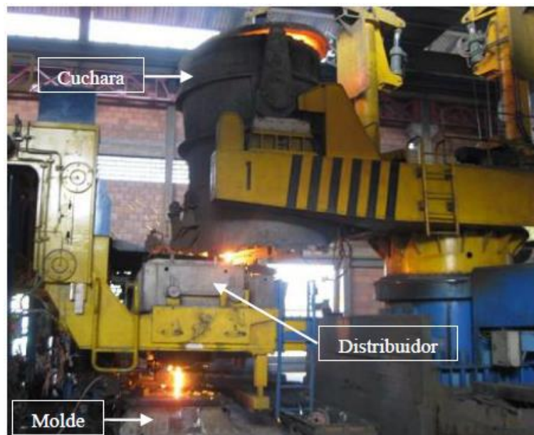
Figura 5. Área de colada continua, parte superior
