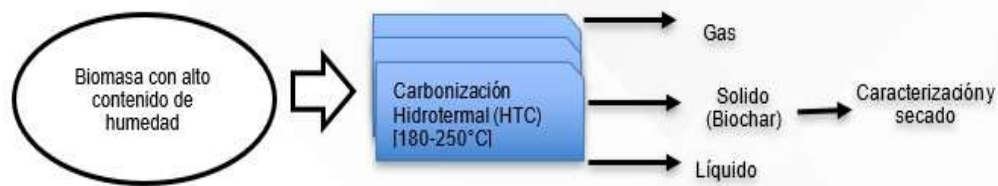
Figura 2. Presentación del proceso de carbonización hidrotérmica Fuente: Yaashikaa et al. (2020).
