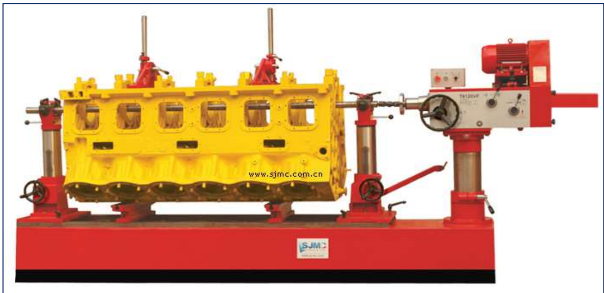
Figura 30 Equipo para reconstruir bancadas
