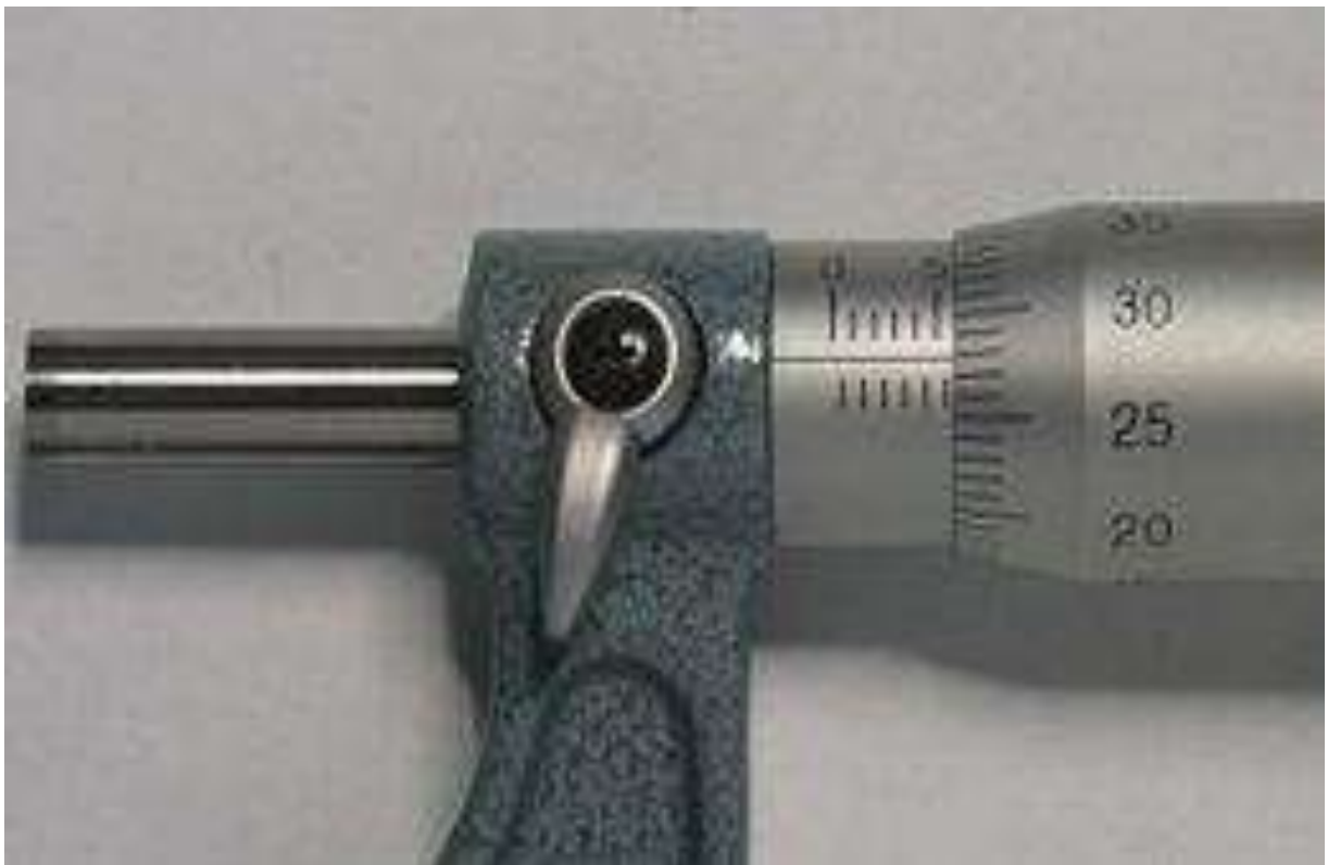
Figura 46 Lectura en el micrómetro
