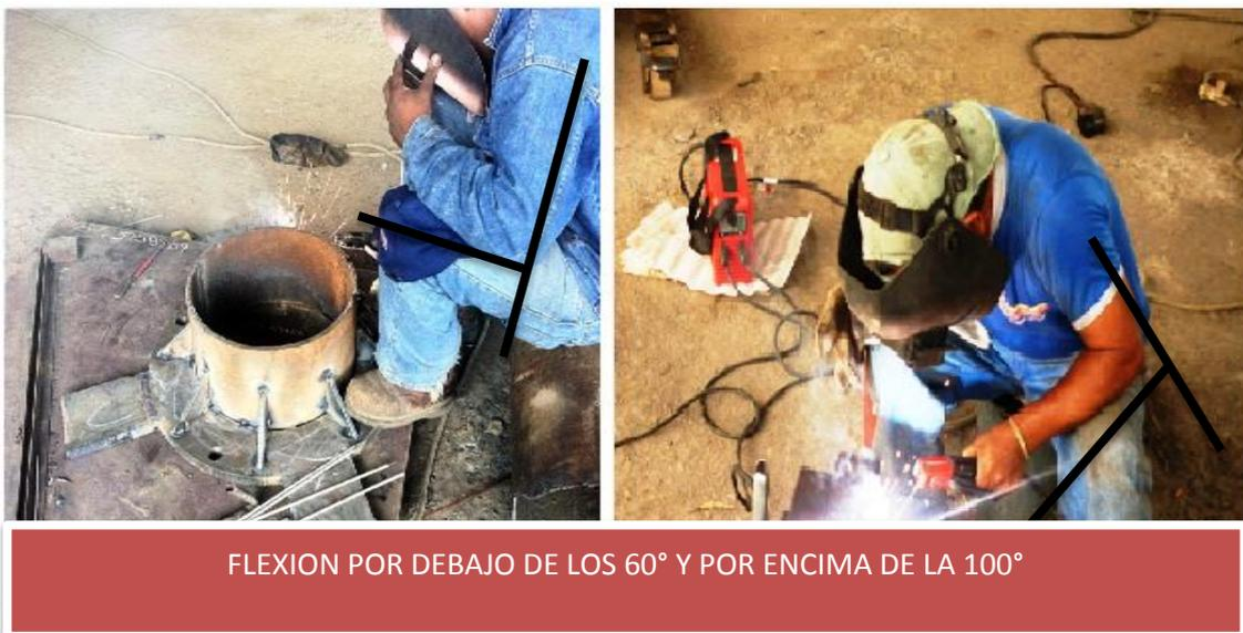
Figura 39. Posición del antebrazo en la soldadura
