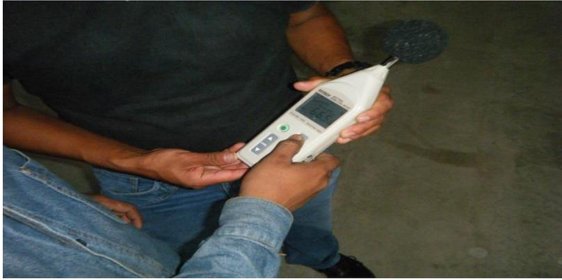
Figura 57. Decibelios del ruido emitido en el área de mecanizado
