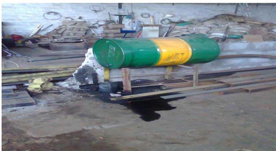
Figura 15. Aceites derramados dentro del área de soldadura
