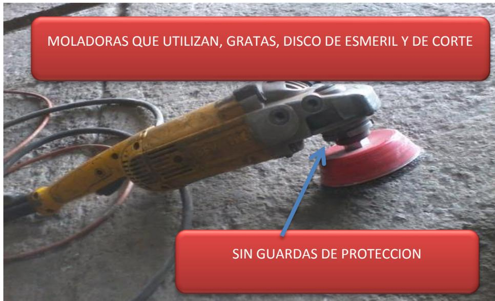
Figura 55. Máquinas de corte sin protección
