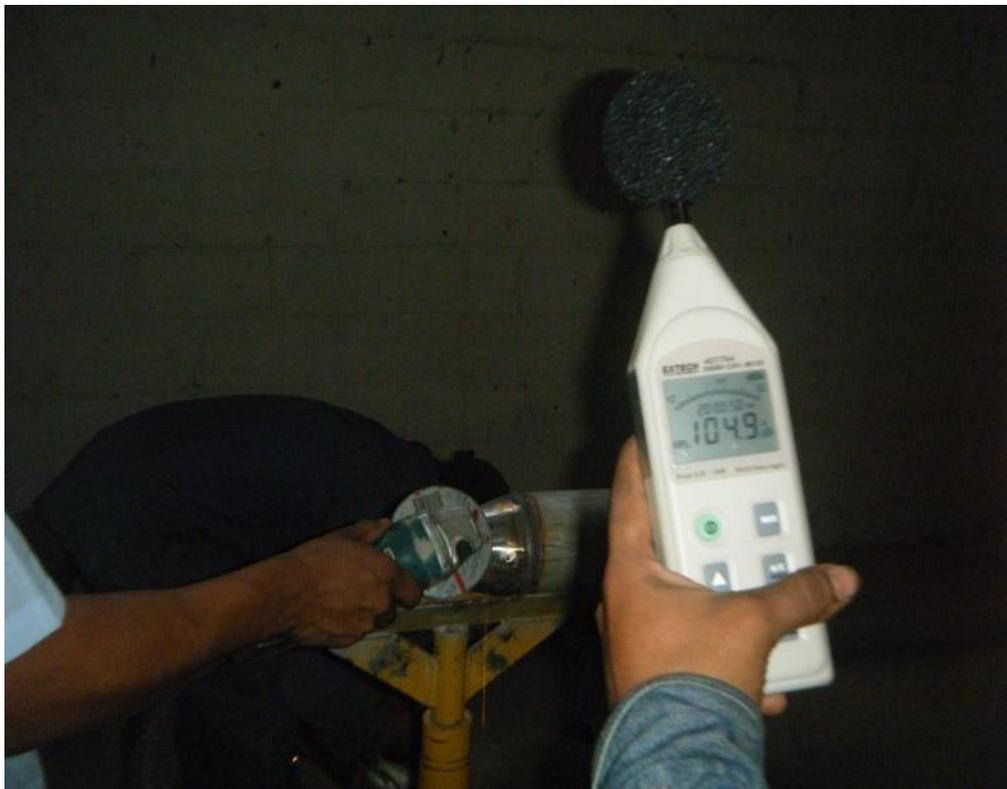
Figura 24. Evaluación del ruido en el área de soldadura
