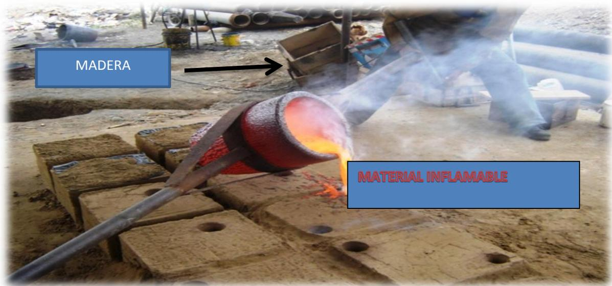
Figura 93. Material altamente inflamable se utiliza
