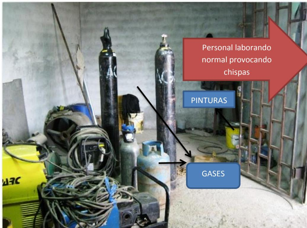
Figura 14. Tipo de almacenamiento de gases
