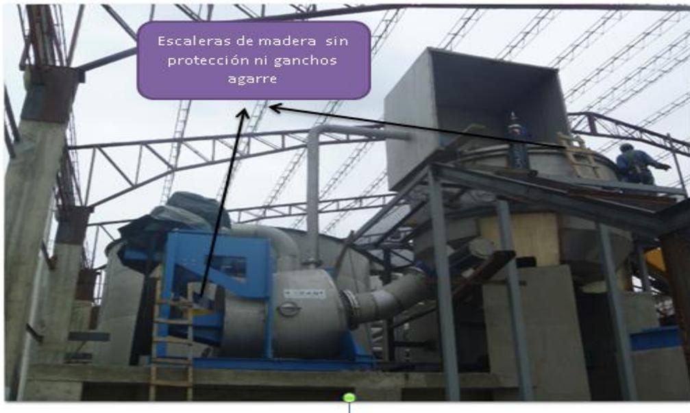
Figura 10. Escaleras en malas condiciones
