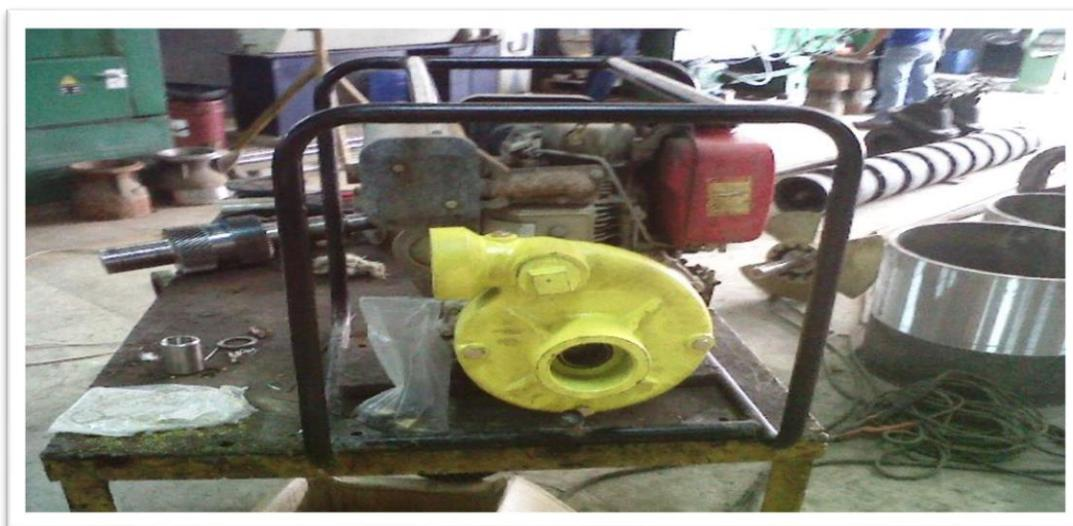
Figura 74. Limpieza se realiza con gasolina
