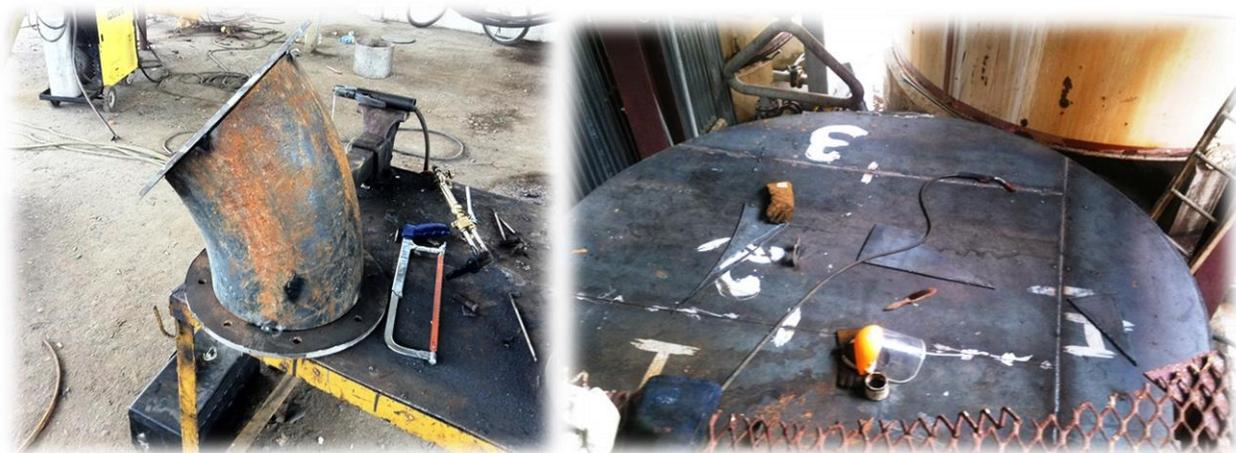
**Figura 76. Realizando cortes con herramientas manuales y eléctricas**
