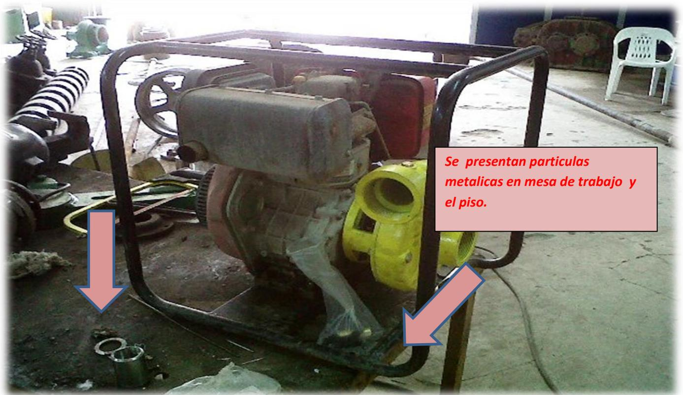
Figura 78. Partículas metálicas que pueden producir cortes
