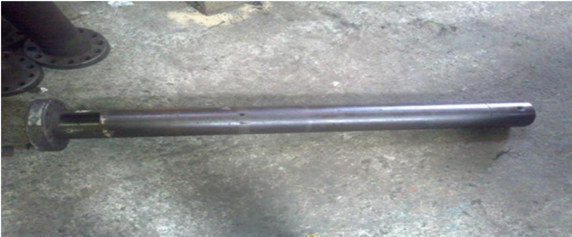
**Figura 19.** Barril de plastificación con desgaste interior
