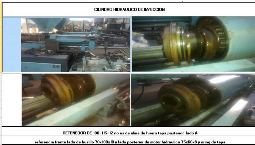
**Figura 10.** Despiece de cilindro hidráulico de inyección referencia técnica de retenedores
