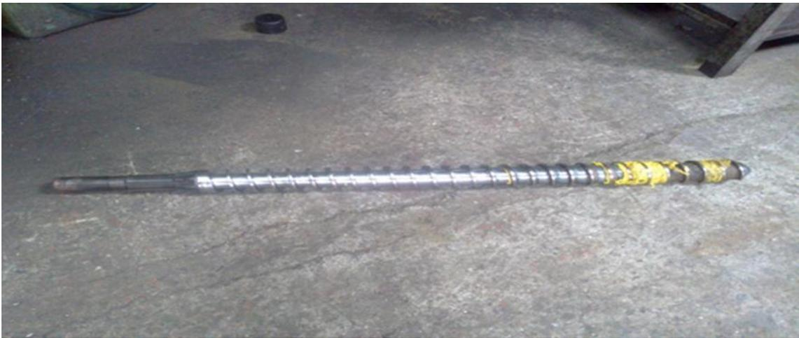
**Figura 20.** Husillo de plastificación con desgaste en área de filetes exterior
