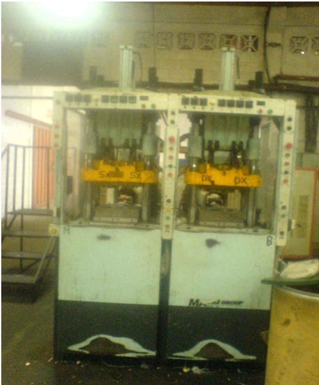
**Figura 3.** Maquinas inyectoras con bomba y motor hidráulico para la inyección del pvc.
