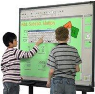
**Pizarra Digital:** Sistema tecnológico, generalmente integrado por un ordenador y un video proyector, que permite proyectar contenidos digitales en un formato idóneo para visualización en grupo. Se puede interactuar sobre las imágenes proyectadas utilizando los periféricos del ordenador: ratón, teclado...
