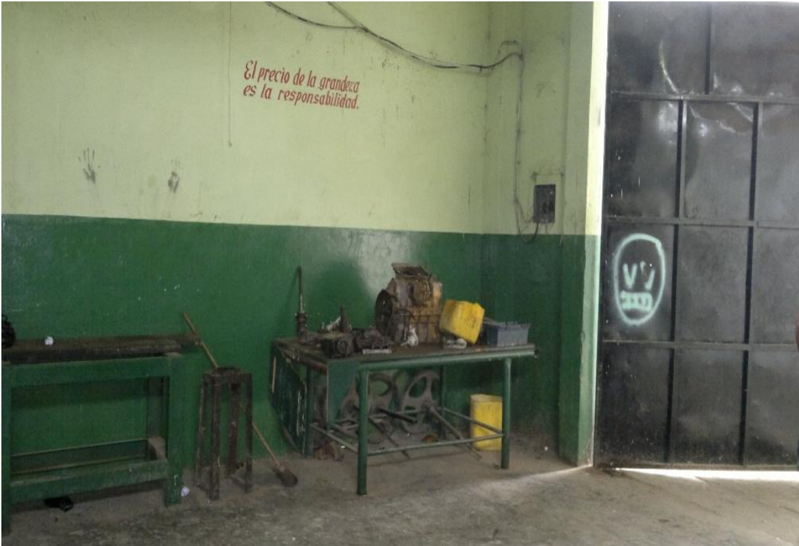
Anexo 2 Taller automotriz almacenamiento inadecuado de combustible.
