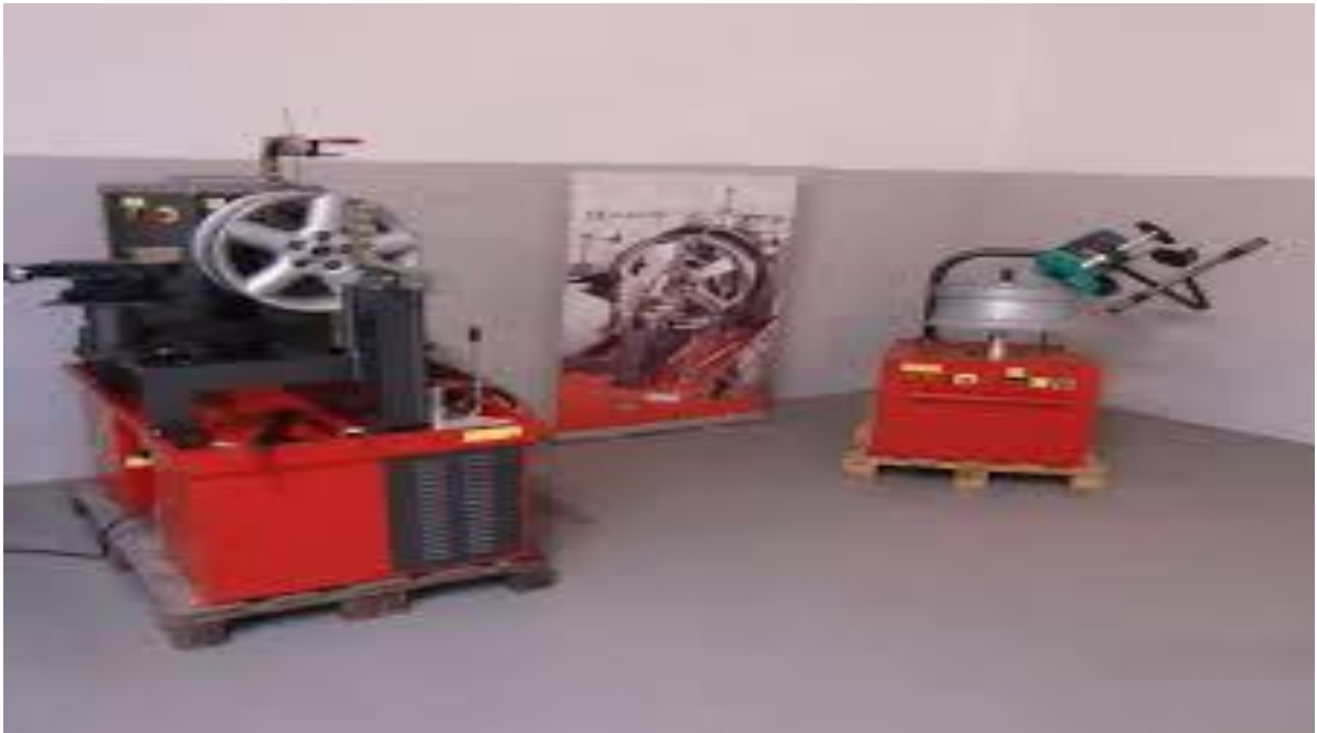
Figura N°3 Enderezado y pulido del aro
