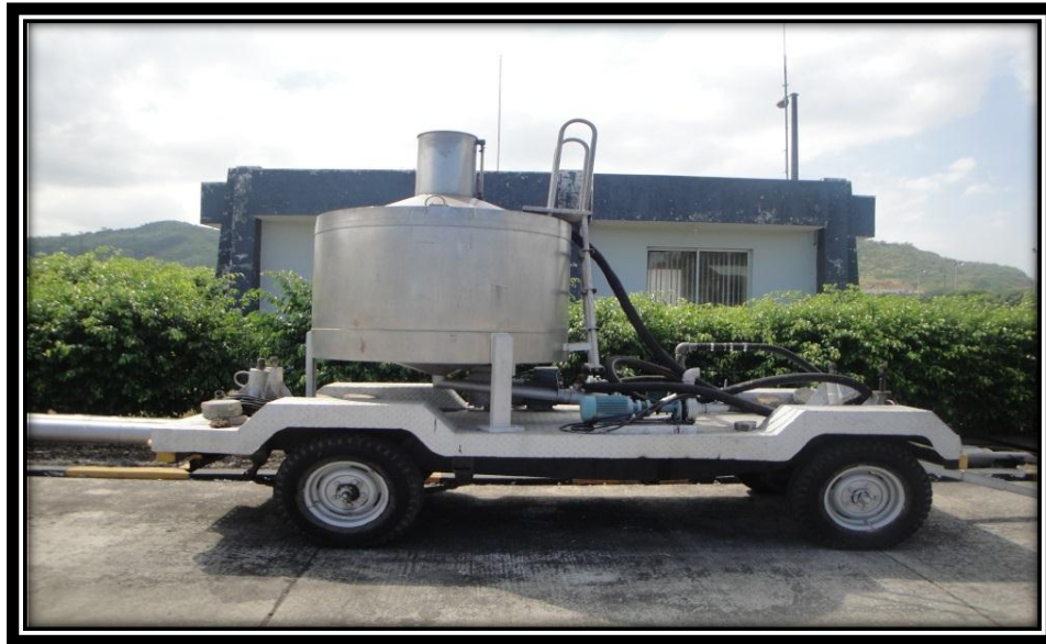
Figura 6: Serafín con capacidad de 500 galones en Terminal Fuel Oil.
