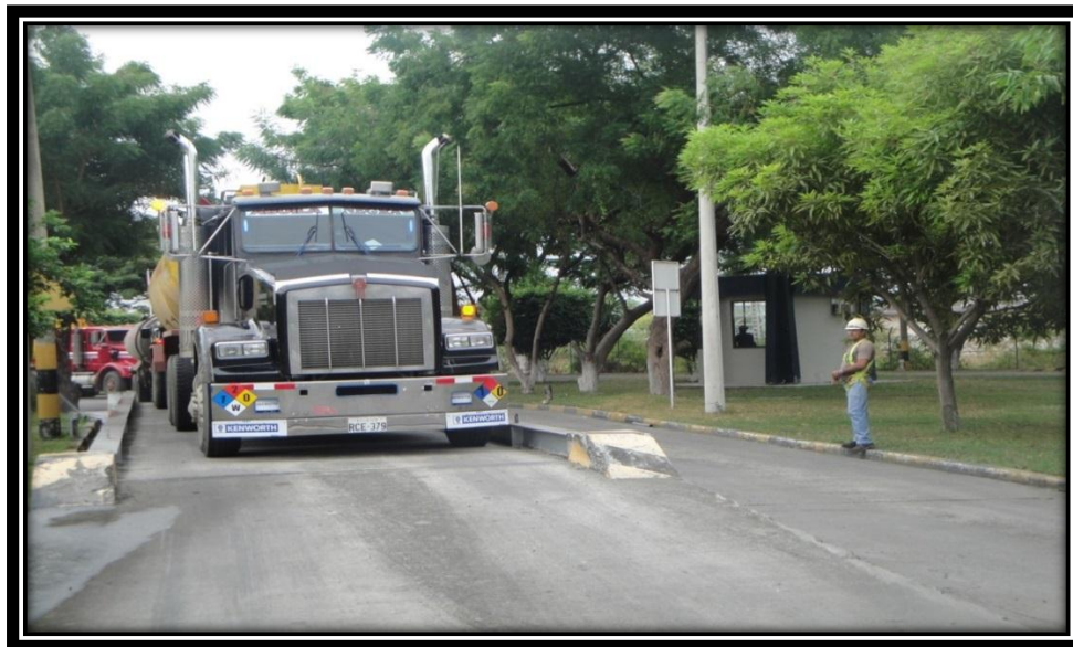
Figura 9: Balanza de entrada y salida en Terminal Fuel Oil.
