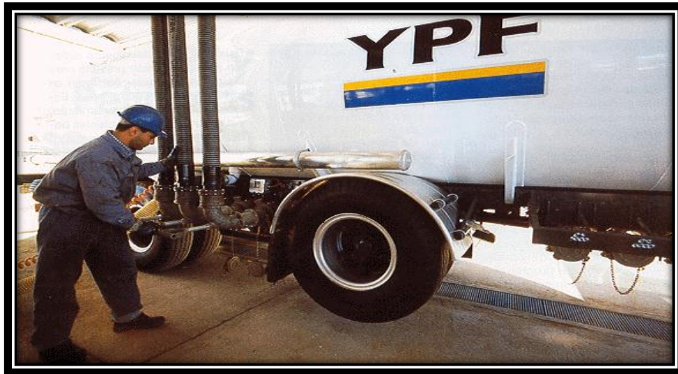
Figura 14: Auto tanque alimentado por sistema de Carga Ventral.
