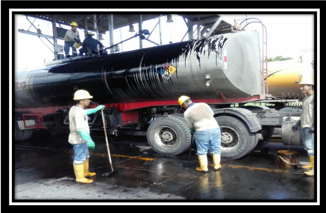
Anexo 7: Derrame de combustible por sobrellenado.
