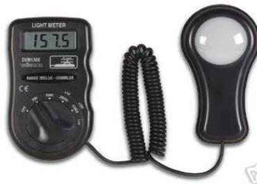
El luxómetro sirve para la medición precisa de los acontecimientos luminosos en el sector de la industria, el comercio, la agricultura y la investigación. Además se puede utilizar el luxómetro para comprobar la iluminación del ordenador, del puesto de trabajo, en la decoración de escaparates y para el mundo del diseño. Cumple con las normas internacionales para este tipo de luxómetros.
