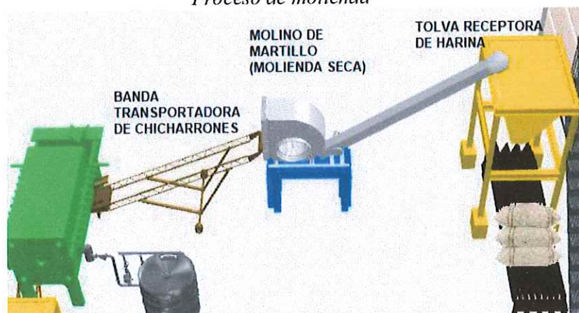
Figura 6 Proceso de molienda
