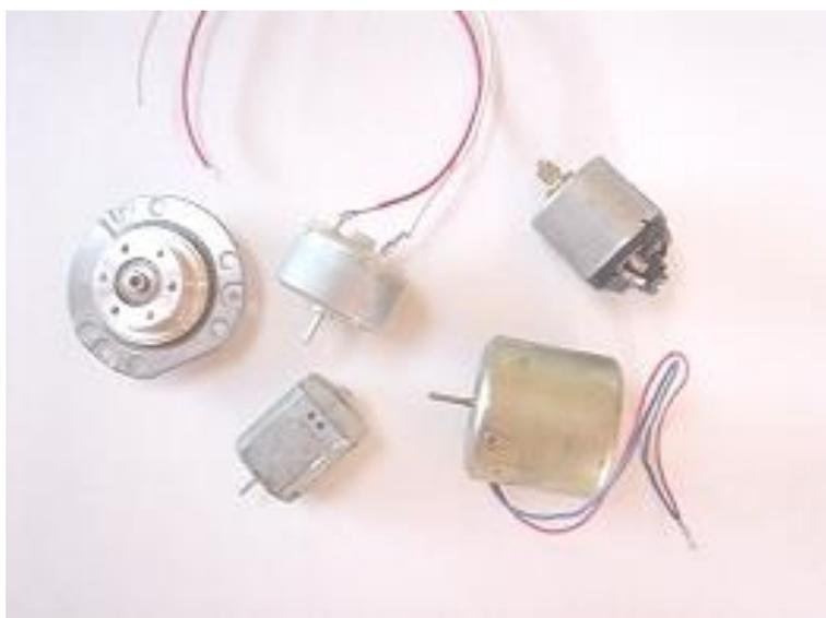
**Figura 17.** Motores para generación eléctrica
