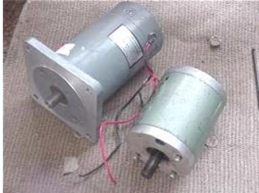
**Figura 33.** Motor de caseteras
