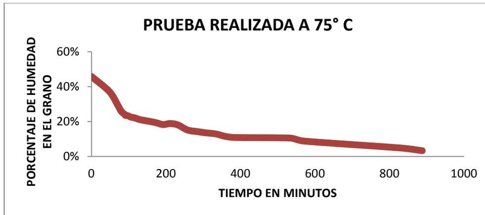
**Gráfico 10.** Representación de la curva de secado en pruebas de secado referenciales.
