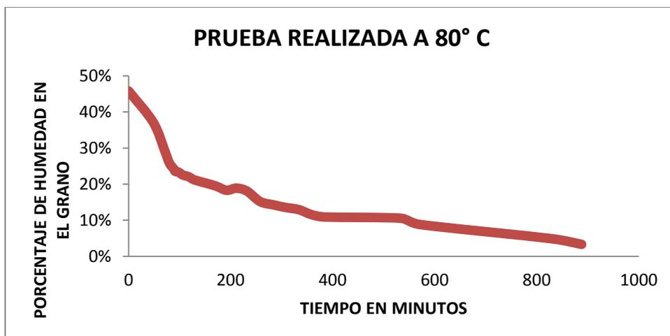
**Gráfico 9.** Representación de la curva de secado en pruebas de secado referenciales.
