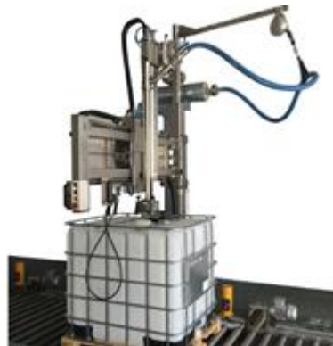
Figura 1.1. Máquina llenadora de líquidos automática para el llenado ponderal Fuente: (AICROV SMART FILLING)
