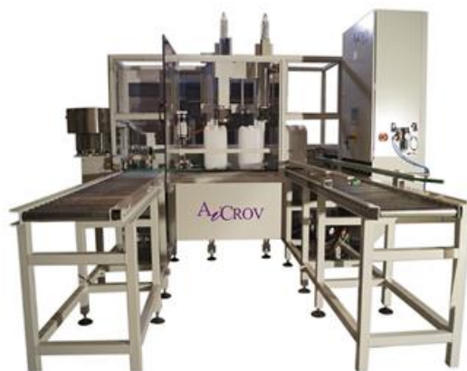
Figura 1.3. Máquina totalmente automática para el llenado ponderal Fuente: (AICROV SMART FILLING)
