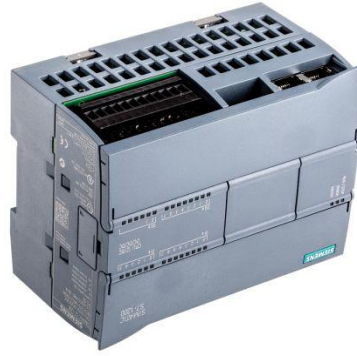
Figura# 4.16: Parte inferior del PLC S7-1200
