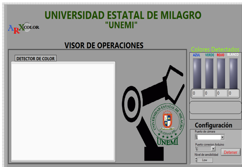
Figura 30: Diseño final de la Interfaz del Sistema de Visión por Computadora para la Detección de Colores
