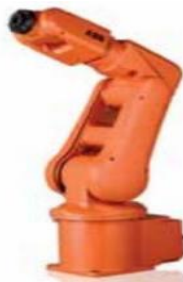
Figura 12: Brazo Robótico ABB IRBI120
