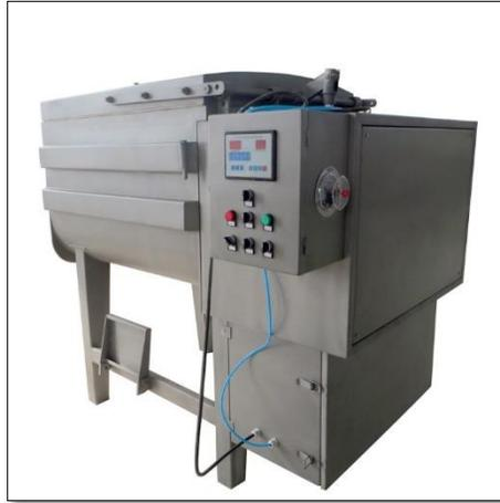
*Figura 2 Máquina mezcladora de carne industrial. (Alibaba, 2021).*
