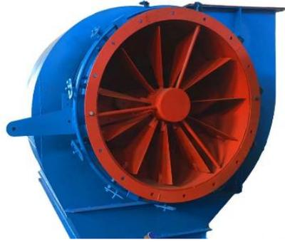
*Figura 6.* Ventilador de tiro forzado para caldera
