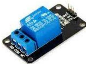
*Ilustración 13 Modulo Relay*
