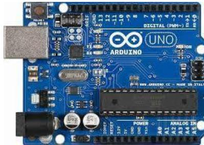
*Ilustración 14 Placa arduino uno*
