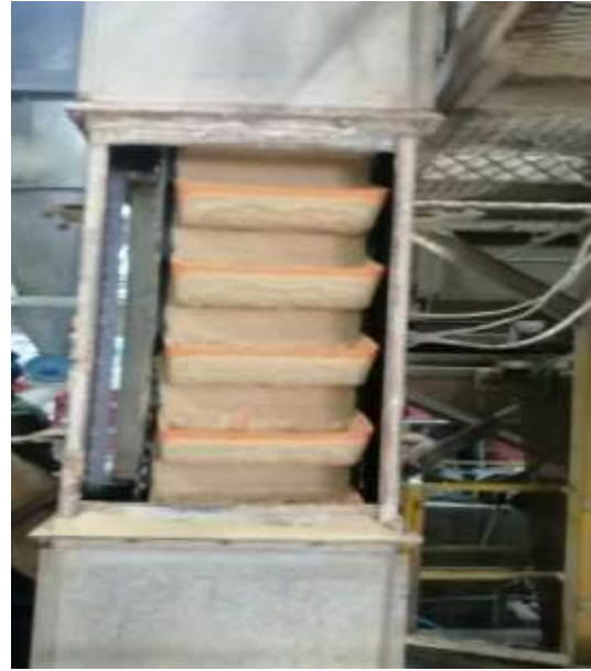
Foto 16. Mantenimiento de un elevador e inspección de banda y cangilones.
