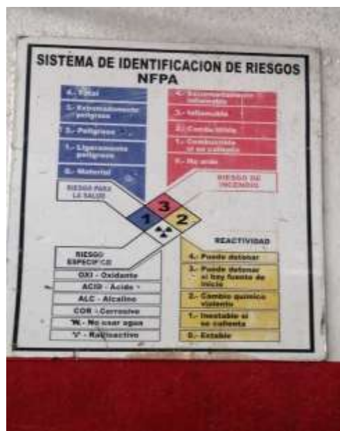
Foto 24. Sistema de identificación de riesgos NFPA.
