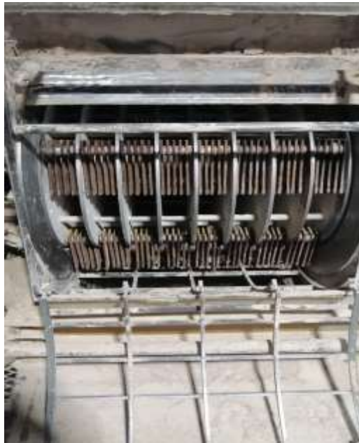
Foto 26. Cambio de martillos de un molino Muyang.
