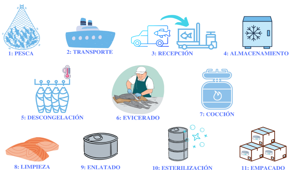
Figura 6: Proceso para elaborar los atunes enlatados
