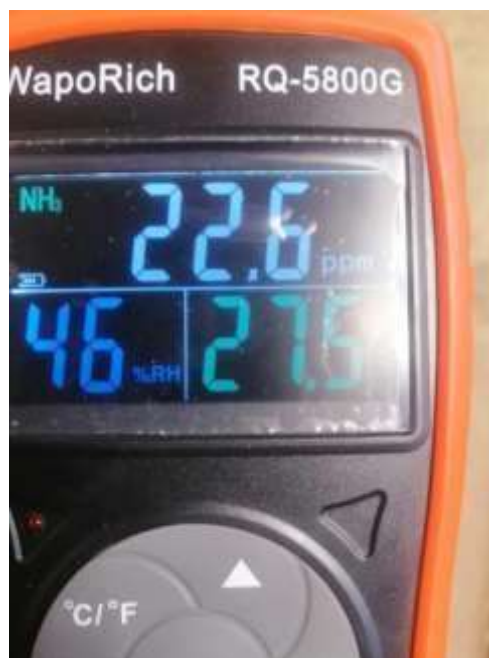
Imagen 1. Medición antes de iniciar el ensayo, valores superiores a 20PPM de \text{NH}_3
