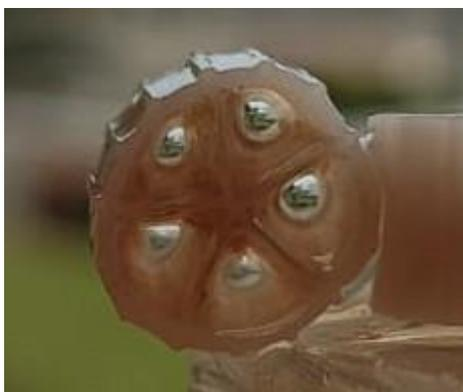
Figura 6. Material de soporte con biomasa adherida
